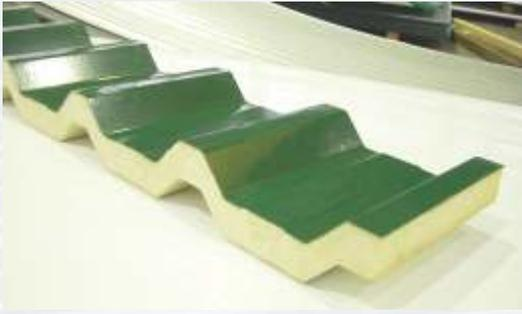
É constituída de duas telhas trapezoidais com núcleo e poliuretano expandido, formando um conjunto rígido, conhecido como sanduíche. É utilizada quando a aplicação exige um excelente desempenho termoacústico, que é obtido através do uso do PU, material que possui a melhor capacidade isolante entre os diversos materiais existentes.
