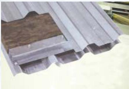
As telhas com isolamento de lã de vidro ou rocha possuem um sistema com bom desempenho termoacústico e mais econômico. Inicialmente são montadas as telhas inferiores, depois são colocados os espaçadores metálicos e o material isolante, e finalmente a telha superior, que completa o sanduíche.
